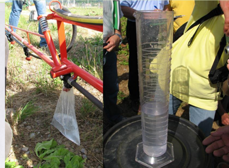
Slika 9. 12: Prikaz načina, na temelju katerega lahko uporabnik izmeri pretok na šobah (M. Per).
