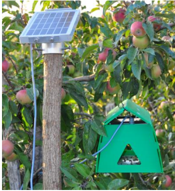
Slika 1: Moderna feromonska vaba, opremljena s kamero za štetje žuželk Trapview
